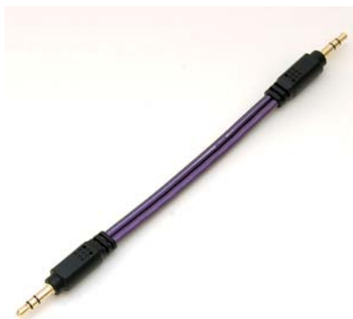
stct_02_3333_012 3.5 3p - 3.5 3p 導体：銀メッキPCOCC 絶縁体：PE シールド：OFC ジャケット：PVC プラグ：金メッキ端子 長さ：0.12m JAN：4534165013651
