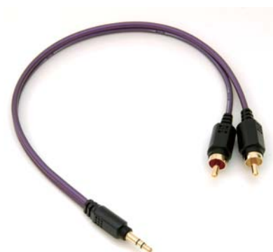
stct_02_33r_030 3.5 3p - RCA(L/R) 導体：銀メッキPCOCC 絶縁体：PE シールド：OFC ジャケット：PVC プラグ：金メッキ端子 長さ：0.3m JAN：4534165013699
